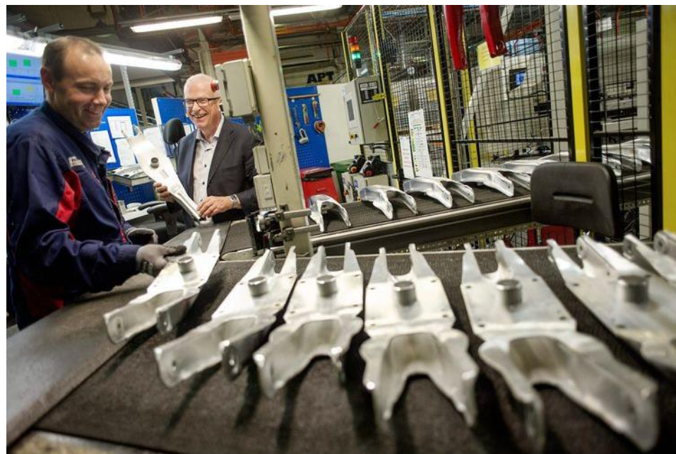
SJEKK. På én dag sjekker Bjørn Kvamsdal rundt 3000 hjuloppheng for feil. Markedssjef i Raufoss Technology, Leif Bronken, mener høy kvalitet gjør at de kan produsere i Norge og eksportere til industrigiganten Kina. Alle foto: Mikaela Berg
