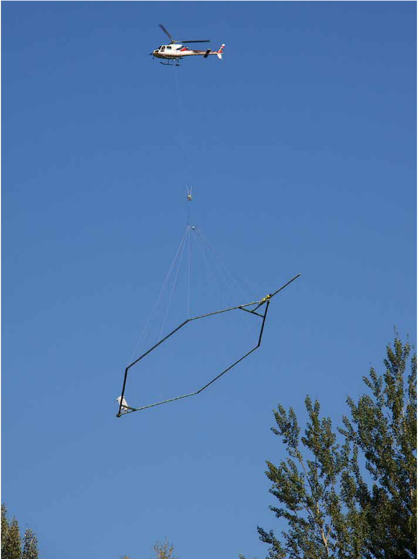
Kartlegging av masser og bergarter ved hjelp av elektromagnetiske bølger, rv. 4 Hadeland. Foto: Frank Andersen
